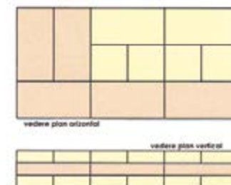
MODUL DE DISPUNERE A GEOCONTAINERELOR ÎN STRUCTURĂ COMBINATĂ
